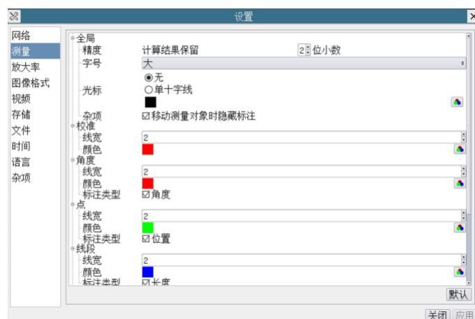
图 6-9 综合设置测量设置界面
