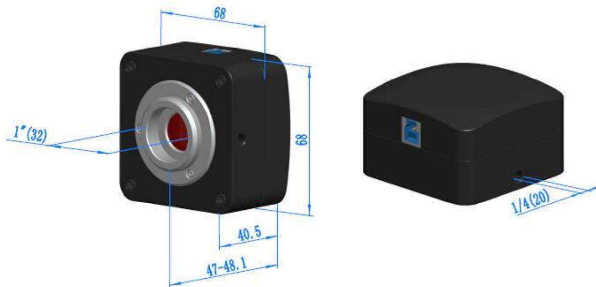
U3CCD 系列相机的外形尺寸示意图
