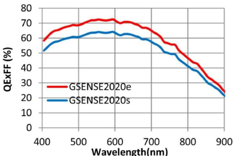
GSENSE2020e 和 GSENSE2020s 的光谱响应曲线
