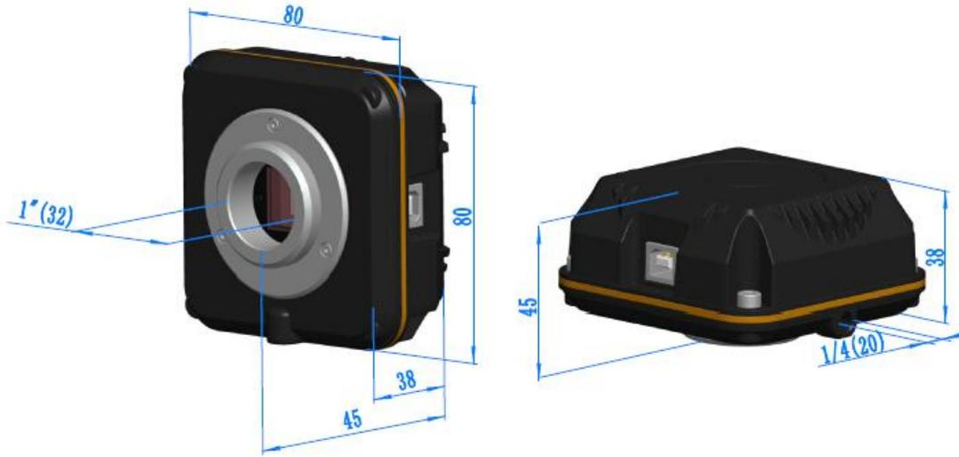
LCMOS 系列相机外形尺寸示意图
