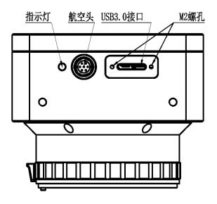
图 3-4 IUCXXX-AFU-EF 相机背面接口示意图
