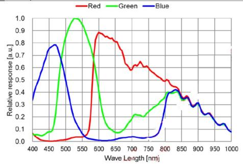
图 2-2 IUC26000KPA-AFU-EF 光谱响应曲线
