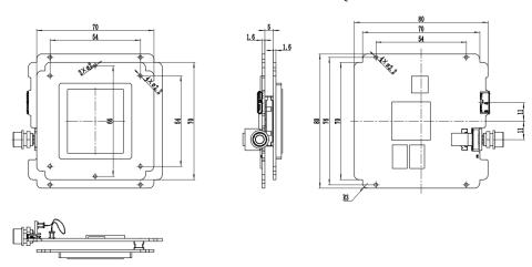
图 3-3 IUCXXX-AFU-EF 裸板尺寸(单位: mm)
