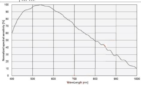
图 2-3 IUC60000KMA-AFU-EF 光谱响应曲线
