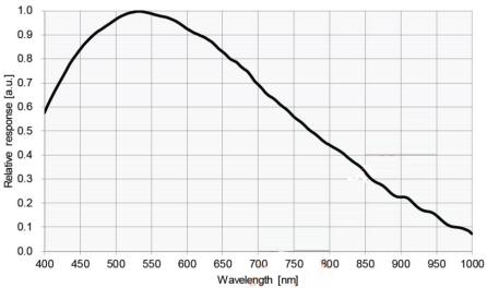
图 2-1 IUC26000KMA-AFU-EF 光谱响应曲线
