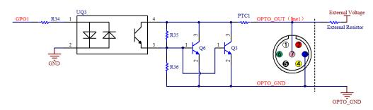
图 4-3 光耦输出电路
