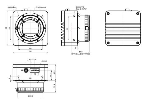
图 3-2 IUCXXX-AFU-EF 整机尺寸(单位: mm)
