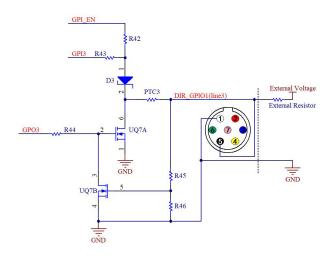
图 4-6 非隔离可配置输入输出 I/O 电路(line3)
