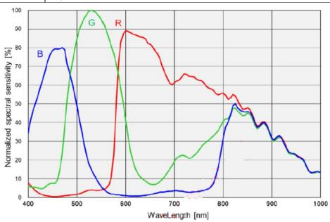
图 2-4 IUC60000KPA-AFU-EF 光谱响应曲线
