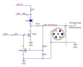
图 4-5 非隔离可配置输入输出 I/O 电路(line2)
