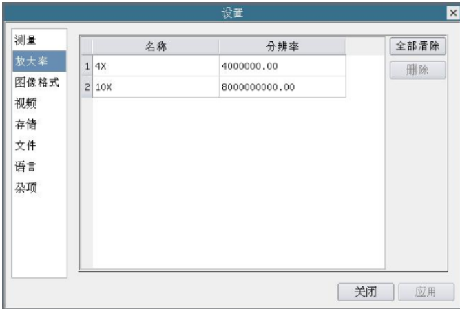
图 6 综合设置测量用单位定标放大率清空与删除设置界面
