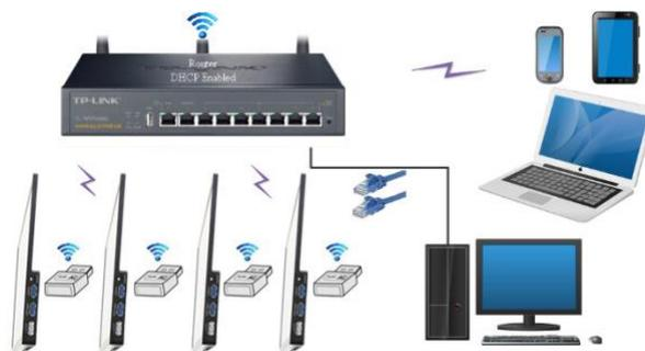
图 10 多台 AIOCAM4K 系列一体相机通过 WiFi 连接到路由器
