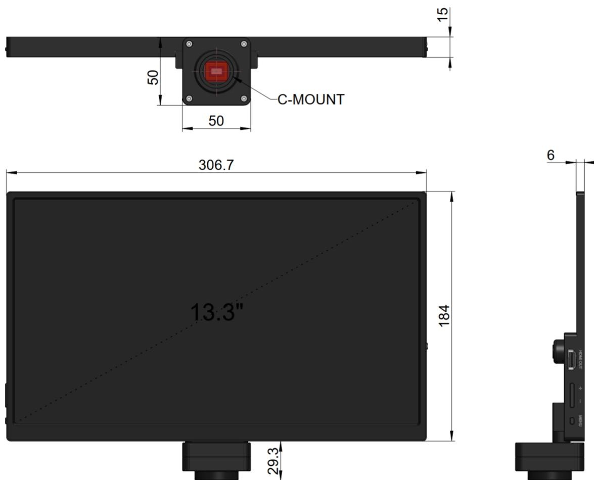
图 3 AIOCAM4K 系列一体相机尺寸示意图
